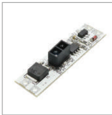
132. Dimmer Por Infrarojos Para Tira LED
